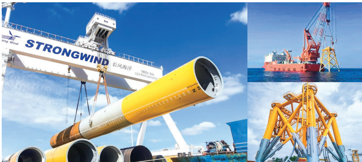
洋上風力向け、風車を支える基礎部材
